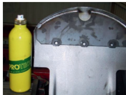
Nachfüllbare Sprayflasche von Protec mit Druckluftventil im Boden für den Spritzerschutz beim Schweißen
