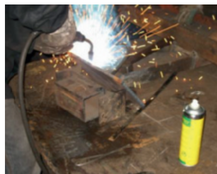
Beim Durchbrennen der Schweißspraydose mit der „Bag-on-Valve“-Technologie besteht Gefahr nur für den Geldbeutel, weil das Treibmittel Druckluft entweicht.
