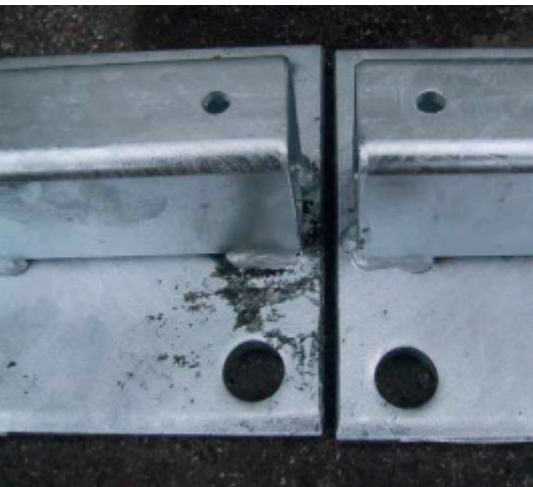
Beeinträchtigung der Feuerverzinkung durch ungeeignetes Schweißspray (links) und nicht unbeeinflusst (rechts) nach Anwendung des Schweißtrennmittels „CE15L“
