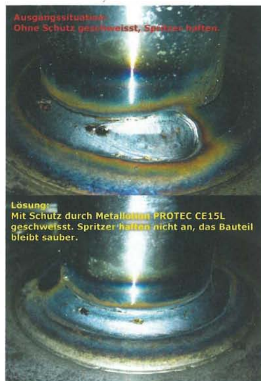
Bild 1 • Metall-Aktivgasschweißnaht; oben: ohne Oberflächenschutz, unten: mit dem Schutzspray (kein Anhaften von Schweißspritzern auf der Oberfläche).
